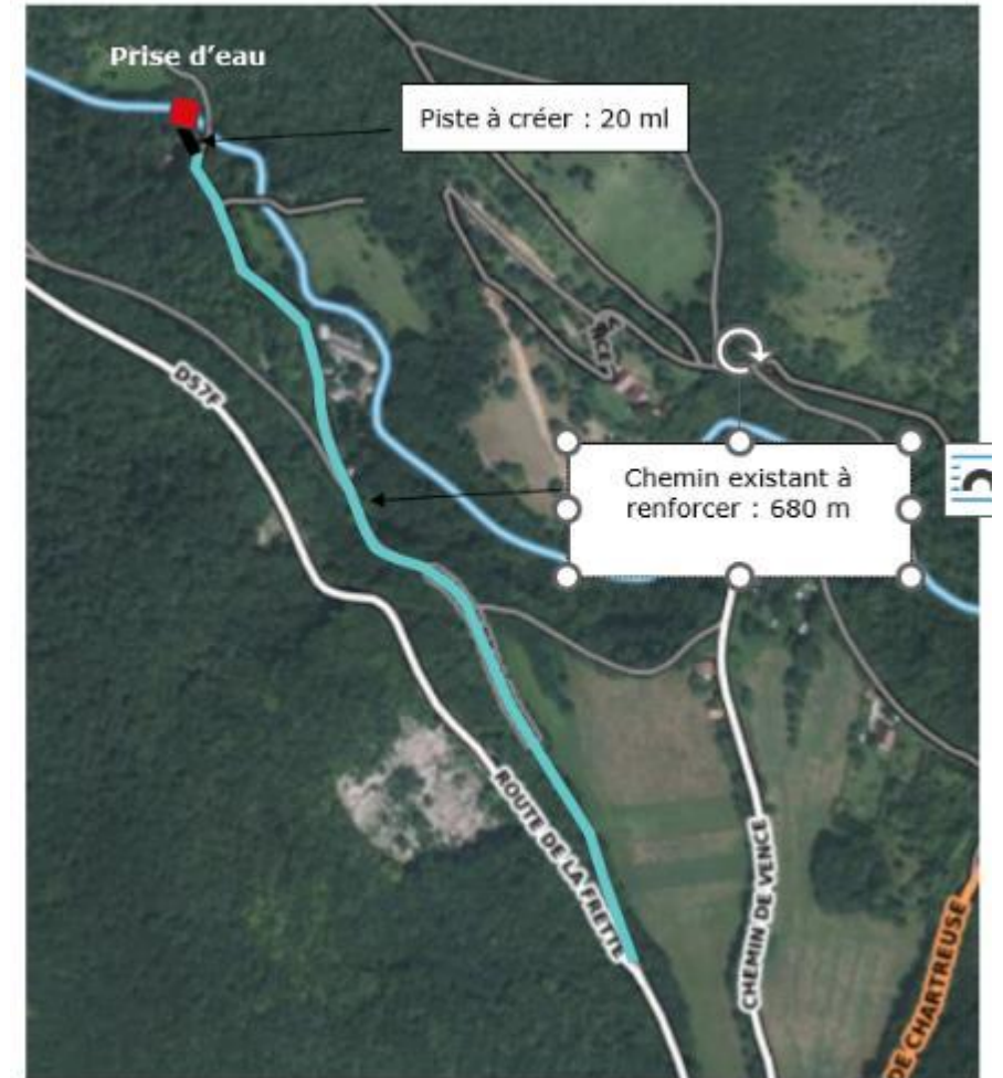
Figure 20 : Piste d'accès à la prise d'eau
